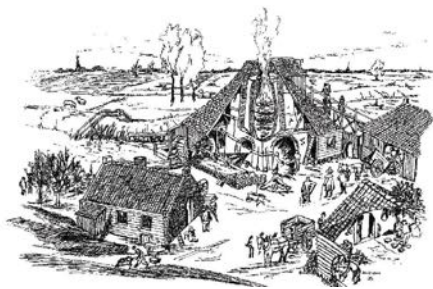
De naam ijzermolen kwam van de waterwiel-aandrijving voor de blaasbalgen die de lucht in de oven blazen
