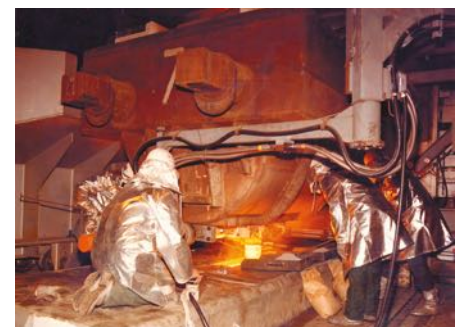
Het uitlopen van het staal uit de verdeelbak in de gietvorm wordt goed in de gaten gehouden
