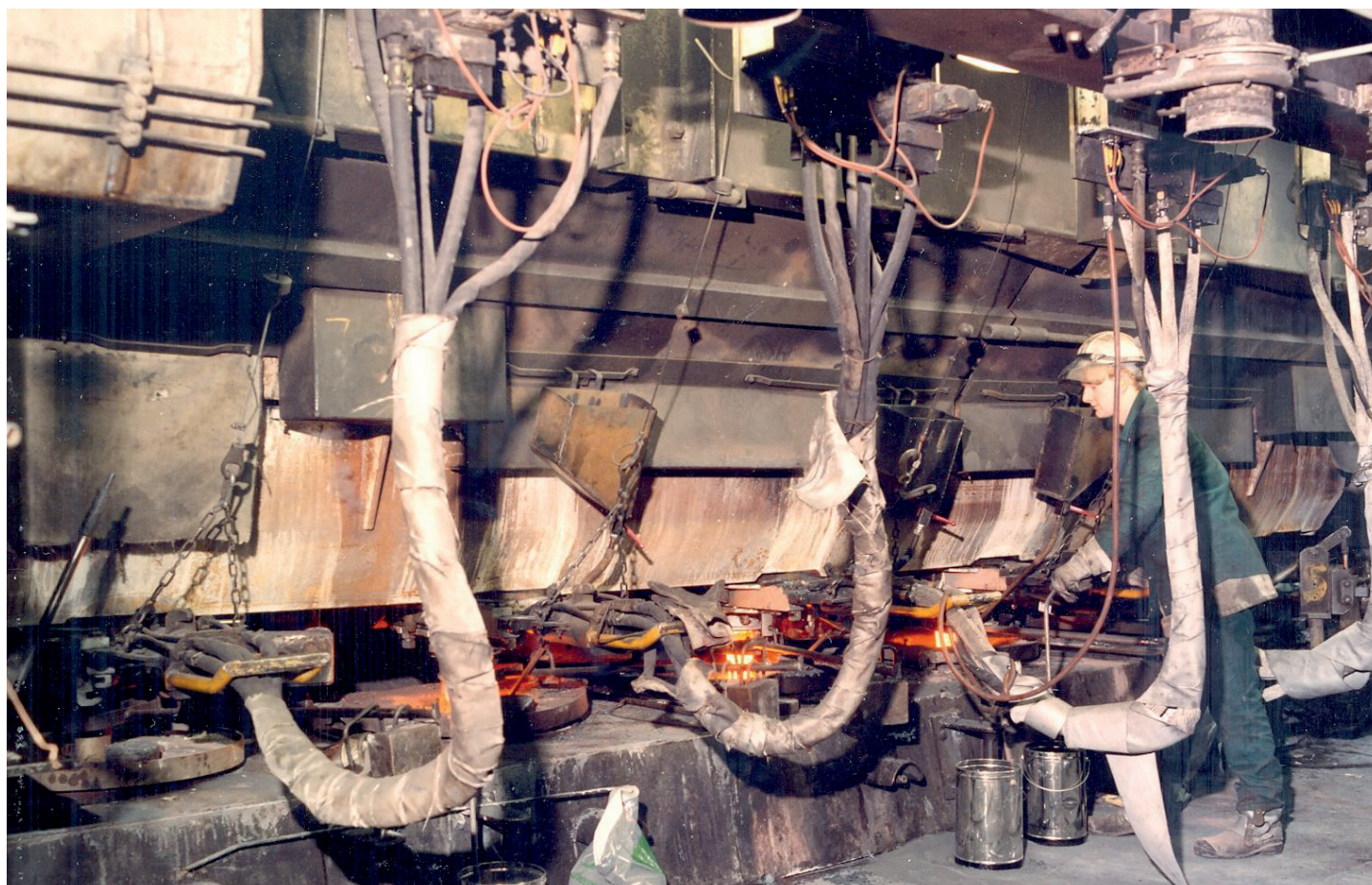
Hier de verdeelbak boven de gietvormen van de knuppelgietmachines
