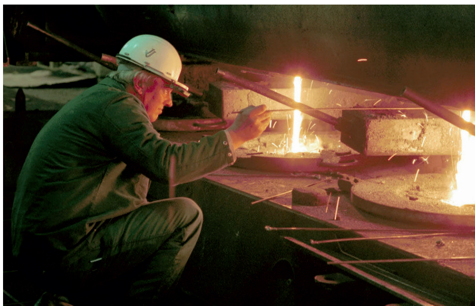
Controle bij het knuppelgieten
